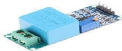
VOLTAGE SENSOR MODULE
